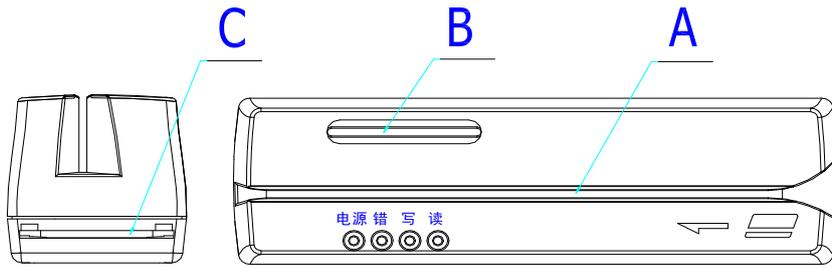
A、MSRE slot B、Main IC card slot C、Sub IC card slot
