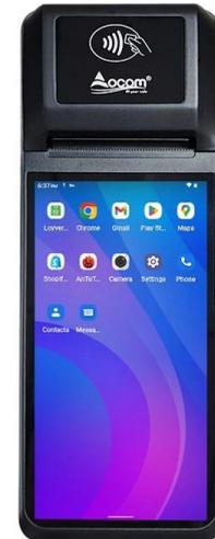
Octa-Core, T606, 2\*Cortex-A75 und 6\*Cortex-A55, bis zu 2,0 GHz-Prozessor;
