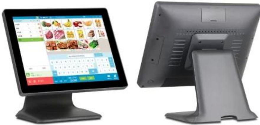
OCOM Série 1513 POS Le terminal a une coque et une base en alliage d'aluminium, il a un processeur intel Celeron et intel core I serie en option, il est facile à installer 2<sup>nd</sup> affichage, RSM, VFD en tant que modules. Ce modèle est très pratique pour la maintenance en retirant le capot arrière et il dispose d'interfaces d'E/S riches pour être connecté à davantage de périphériques externes
