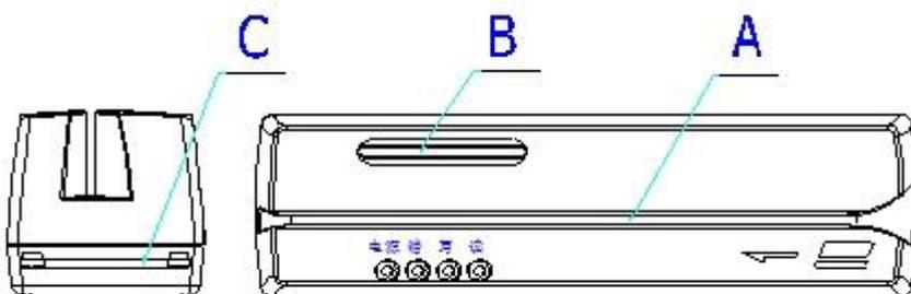
A, Slot MSR B, Slot Card de carte IC principale C, Sous-Ic Card Slot
