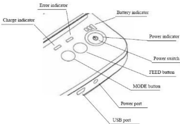
**[CHARGE]:** Battery charge indicator      **[ERROR]:** Error indicator
