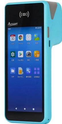
Module d'imprimante thermique haute vitesse 58 mm intégré ;
