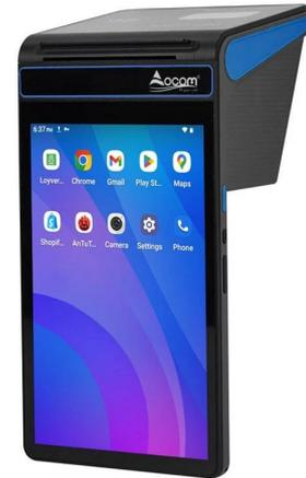
T8&T8R est un Android POS avec 80 mm ou 58 mm Reçu et étiquette imprimante, il a une bonne conception d'identification et CMF. Intégrer 8 pouces tactile écran, système d'exploitation Android et Dual SIM 4G LTE, Wi-Fi, Bluetooth, GPS communication.
