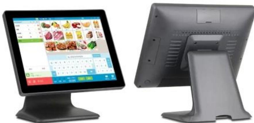
OCOM serie 1513 POS il terminale ha guscio e base in lega di alluminio, ha Intel Celeron e CPU Intel Core I serie per opzione, è facile da installare 2<sup>nd</sup> Schermo, MSR, VFD come moduli. Questo Modello è molto comodo per la manutenzione rimuovendo il coperchio posteriore e dispone di ricche interfacce I/O per essere collegato a più dispositivi esterni
