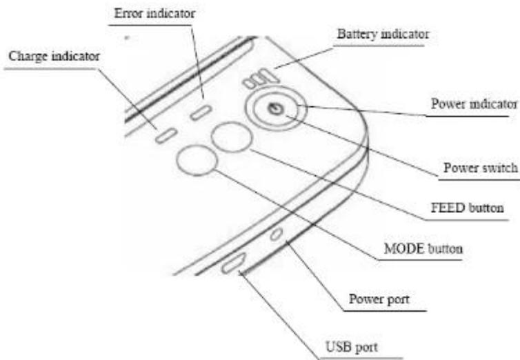
**[CHARGE]:** Battery charge indicator      **[ERROR]:** Error indicator
