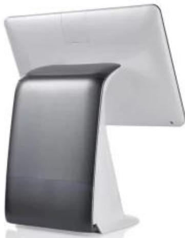
Кабельное управление, открыть и закройте заднюю крышку без инструментов
