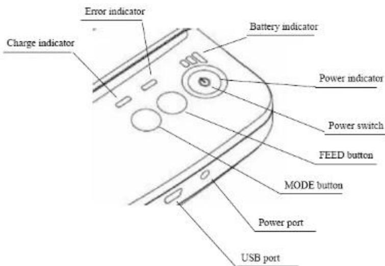
**[CHARGE]:** Battery charge indicator      **[ERROR]:** Error indicator
